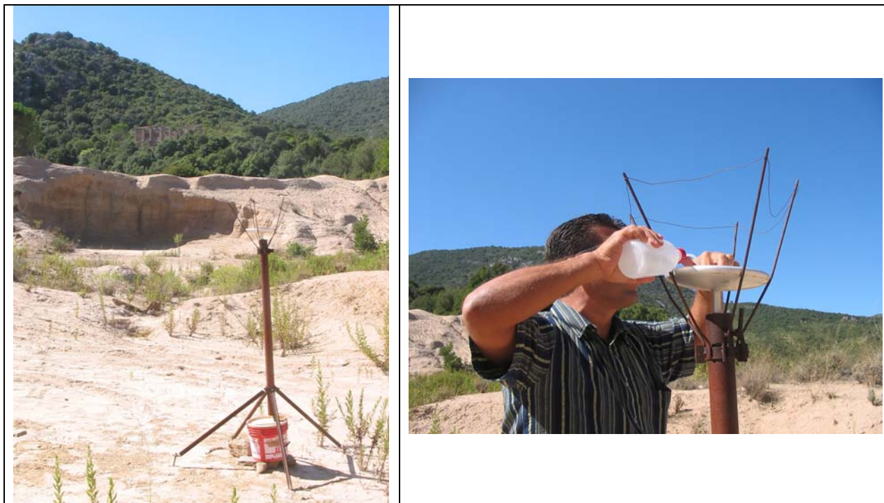
Figura 2.8. – Prelievo di polveri sedimentabili attraverso un deposimetro modello "frisbee"
